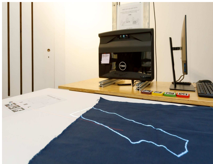
Abbildung 11: Projektion eines Schnittmusters (Foto: Stefan Effenhauser)
